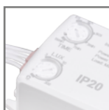
SES25WH regulacja TIME (10s÷15min) i LUX (3÷2000lux)
